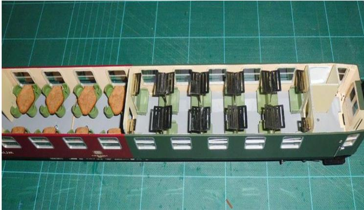
Die Innenausstattung wird in das Wagengehäuse festgeschraubt mit 1.8 mm Schrauben.
